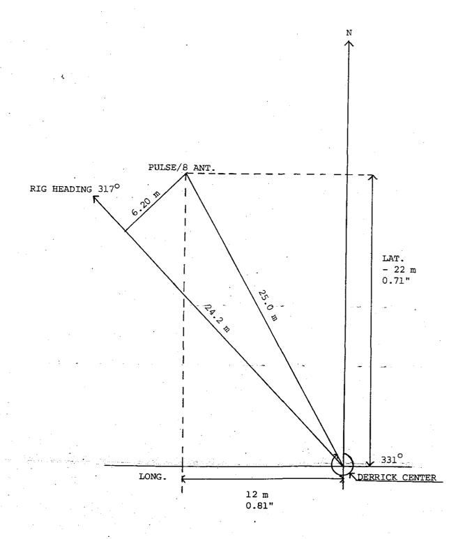
APPENDIX NO. 8 COMPARISON BETWEEN INTENDED, FINAL SATELLITE POSITION AND PULSE/8 SYSTEM POSITION.
