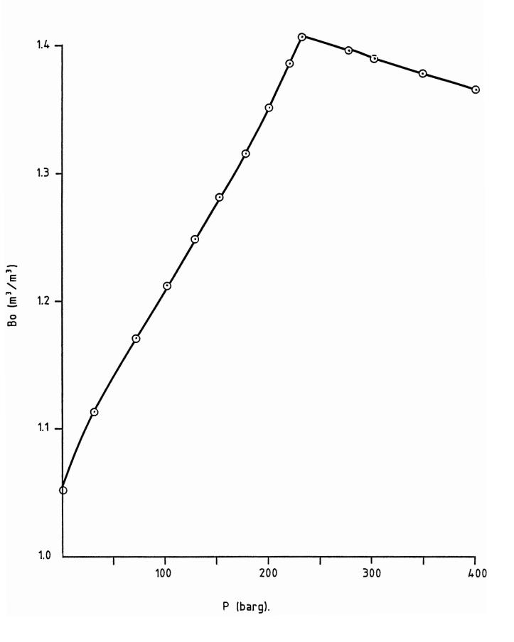
FIG.4. DIFFERENTIAL LIBERATION AT 74.6°C SOLUTION GAS-OIL RATIO.
