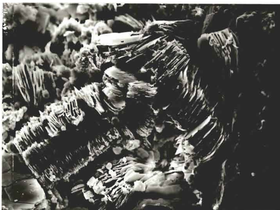
Fig. 37 Brønn 34/10-8. Dyp 1975,4 m. Etive. Aggregat av kaolinit-krystaller i pore slik det observeres med elektronmikroskopet. Trekkspill-lignende krystall-rekker ligger retningsløst orientert. Bredden på rekkene er 5 - 10 mikron. Merk den høye mikroporositeten i aggregatene.
