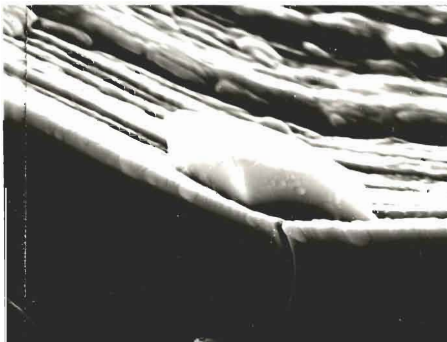
Fig. 47 Brønn 34/10-4. Dyp 1872,19 m. Rannoch. Fremvekst av rhombeformet sideritt-krystall langs spalteflate i glimmer. Krystallens lengde er ca. 10 mikron.
