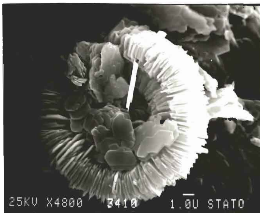
Fig. 40B Brønn 34/10-3. Dyp 2009,40 m. Rannoch. Nærbilde av sirkelformet aggregat av kaolinitttkrystaller vist i fig. 40A. Aggregatet er dannet ved at en enkelt rekke av krystaller har vokst i spiralform. Sentralt i aggregatet sees kaolinitttens sekskantede krystallform. Hvit strek ned til høyre tilsvarer 1 mikron.
