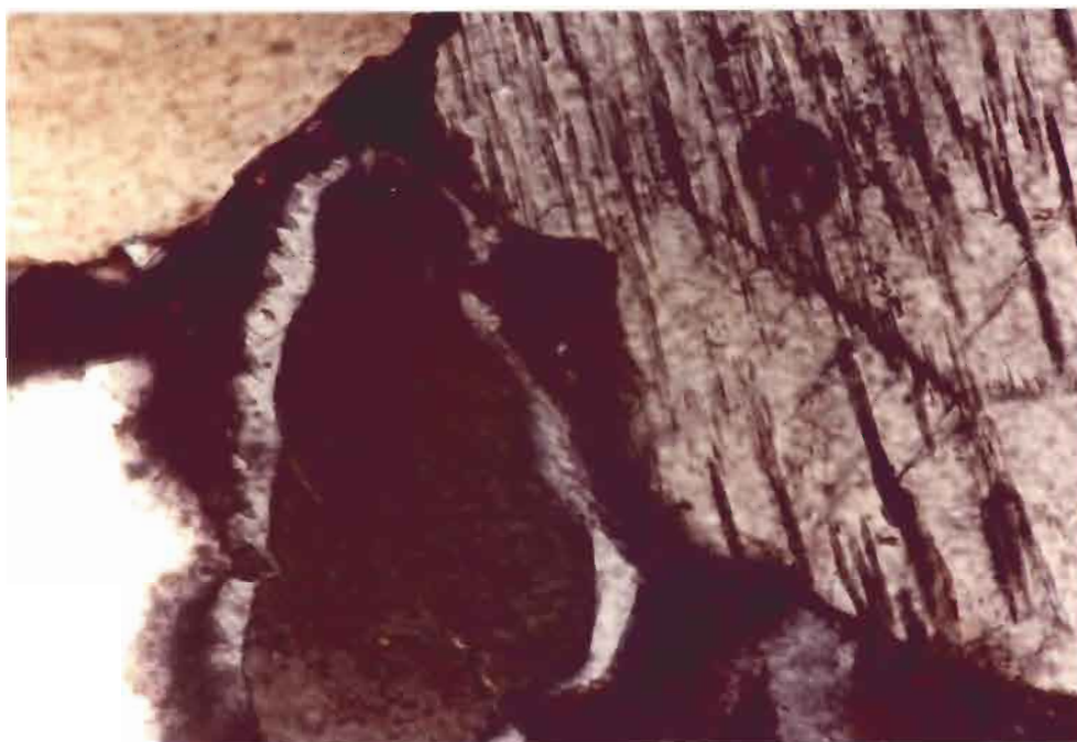
Fig. 41 Brønn 34/10-3. Dyp 1990,2 m. Etive. Overvekst av authigen K-feltspat som lys grå krave på sandkorn av feltspat (mørkt - sort). Den taggete ytterkant av overveksten skyldes vekst i forskjellig hastighet ut fra flere vekstpunkter. Bilde fra lysmikroskop.
