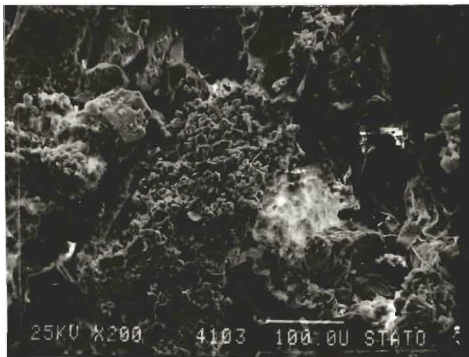
Fig. 45A Brønn 34/10-4. Dyp 1872,20 m. Rannoch. Typisk aggregat av sideritt mikro-krystaller. Lengden av hvit strek tilsvarer 100 mikron. For detaljer se fig. 45B.
