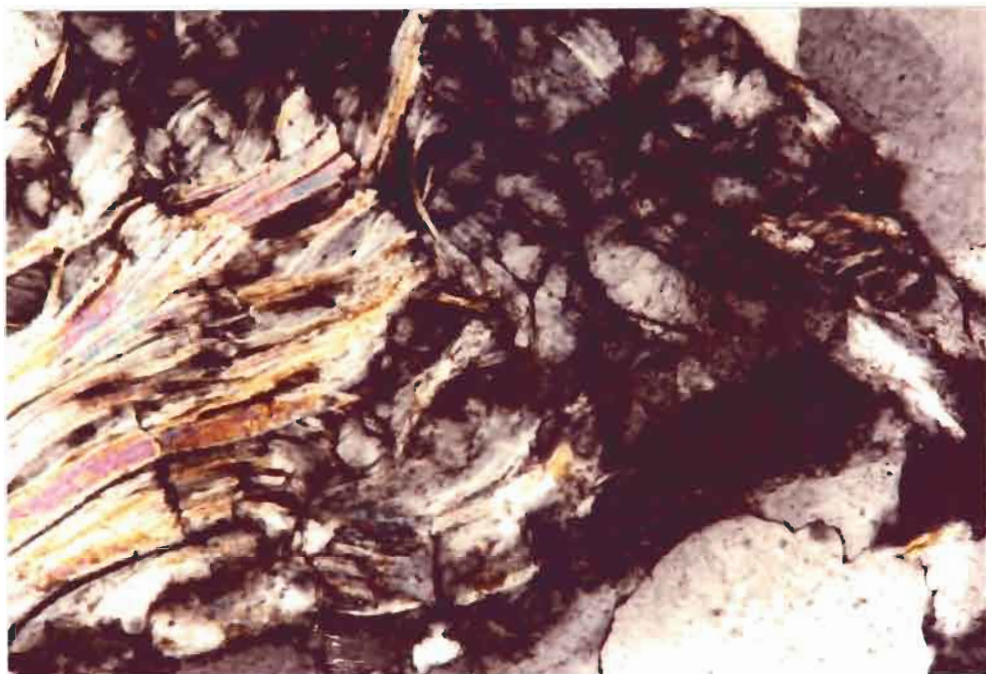
Fig. 36 Brønn 34/10-3. Dyp 1999,60 m. Etive. Omvandling/nedbrytning av klastisk glimmer (gul, rosa, turkis) til aggregater av kaolinit (farveløse, grå) i pore mellom sandkorn. Bilde fra lys-mikroskop.
