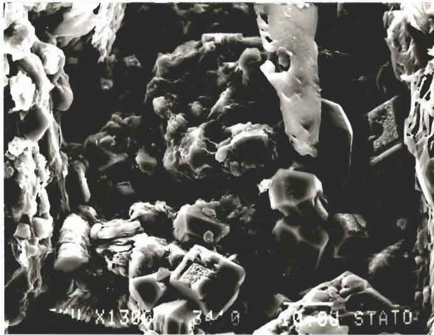
Fig. 51B Brønn 34/10-3. Dyp 2009,4 m. Rannoch. Nærbilde av anatas-aggregat vist i Fig. 51A. Merk krystallenes kiste-form. Hvit strek tilsvarer 10 mikron.
