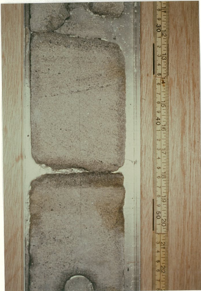
Fig. 5l 1603.30 m Traukryssjiktning i intervall Vc med anriking av pebbles i lamina.
