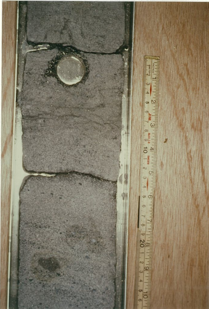
Fig. 5f 1661.10 m Grense mellom reservoar- sone 1B og 1A. Kryssjiktet, konglomeratisk sandstein under og bioturbert siltig sandstein over. Grensen representerer mulig en transgresjon.
