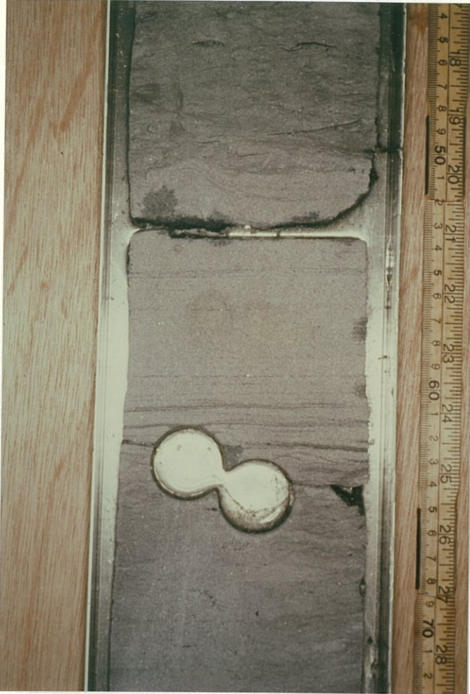
Fig. 5a 1734.50 m Lag på ca. 15 cm av parallellaminert, fin til medium, godt sortert sandstein i en ellers svært fin, gjennom- bioturbert sandstein. Laget er tolket som mulig stormgenerert.
