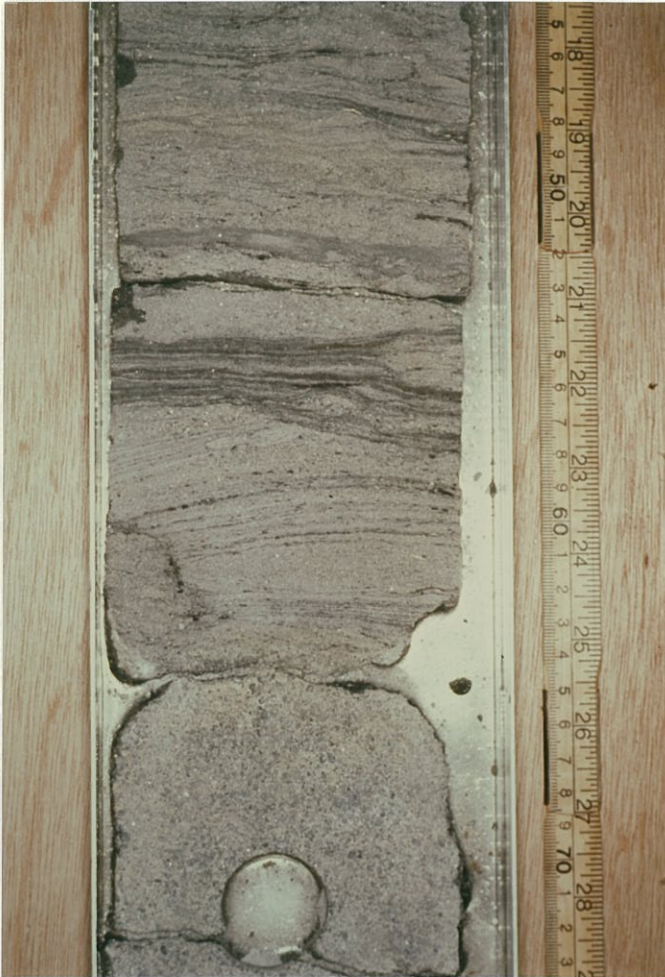
Fig. 5k 1608.6 m Toppen av intervall Vb. Øverst et karbonatsementert konglomeratisk sandsteinlag. Transgressivt? Under ser en laminert, glimmerrik, fin sandstein.
