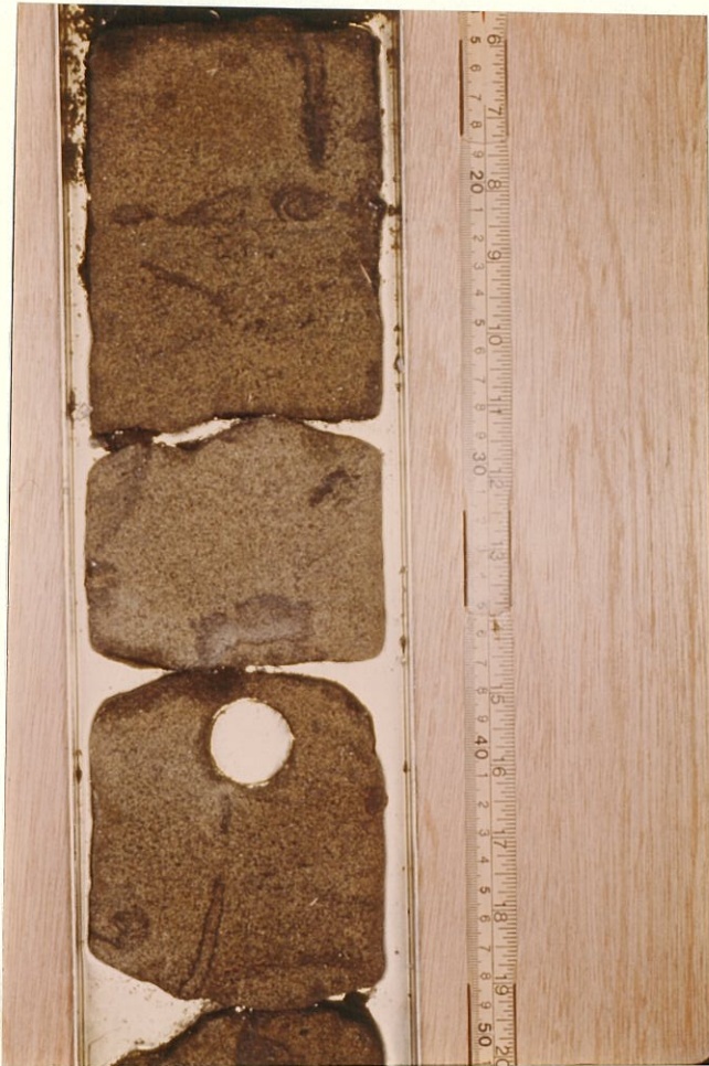
Fig. 5g 1645.0-50 m Vertikale og horisontale gravespor i intervall IVa.
