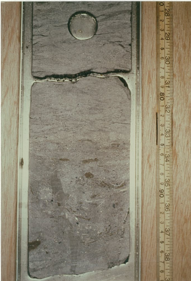
Fig. 5b 1732.80 m Bioturbert(?), fin sand rikt på fragmenter av svart-kull, brunkull og skall i en ellers svært fin, gjennombioturbert sandstein. Også dette laget er tolka som resultat av storm, muleg stormdønningsavsetning.
