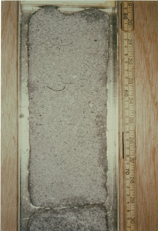
Fig. 5e 1705.50-70 m Konglomeratisk, massiv moderat sortert sandstein nederst i intervall IID med flere molluskskal i ustabil posisjon.
